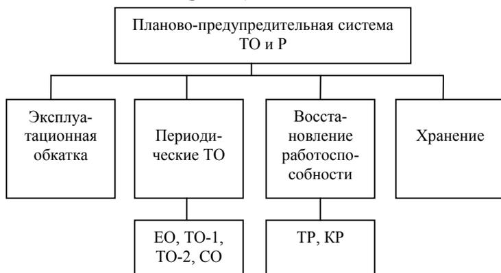
**Рис. 14 - Структура планово-предупредительной системы ТО и ремонтов машин**
