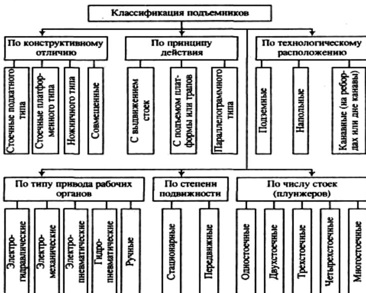
**Рис. 59 – Классификация подъемников**
